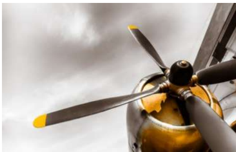
Мал. 15.13 Лопаті пропелера вигнуті так, що попереду них утворюється зона зниженого повітряного тиску, а позаду — підвищеного. Повітря ззаду штовхає пропелер і літак рухається вперед
