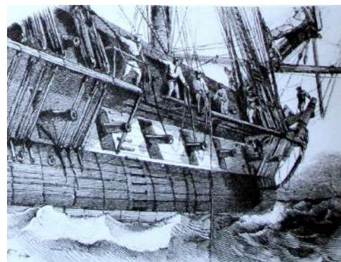
Мал. 10.7. Моряки лотом вимірюють глибину. Лише гиря сягає дна, замірюють довжину мотузки, що й дорівнює глибині в цьому місці
