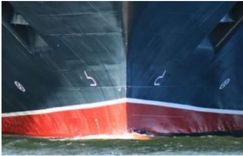
Мал. 5.3. Ватерлінію позначають ззовні корабля контрастними фарбами, щоб її було добре видно
