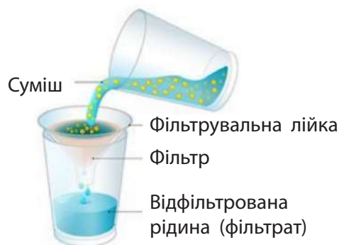
Мал. 2.5. Фільтрування. Вода та розчинені речовини проходять крізь фільтр, а великі часточки — ні
