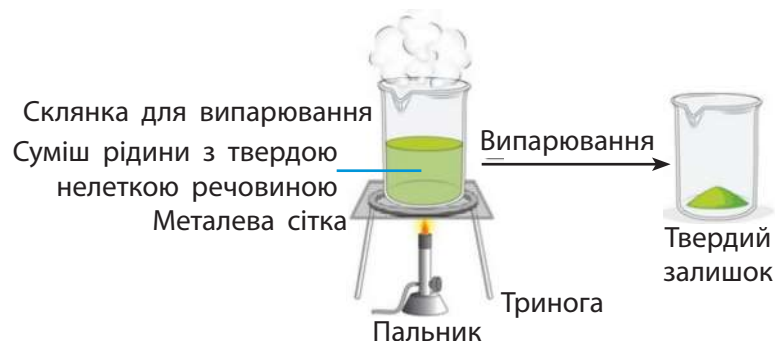
Мал. 2.7. Випарюванням можна відокремити нелетку речовину з розчину
