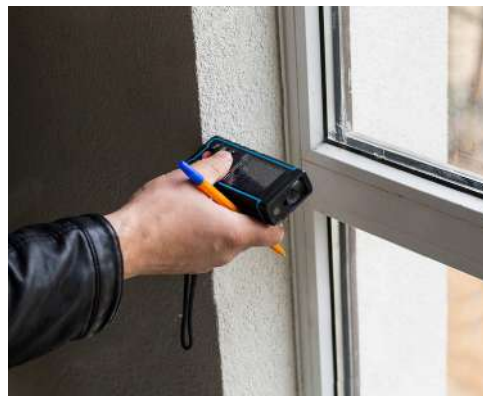
Мал. 36.1. Лазерний далекомір вимірює відстань за допомогою принципу «відлуння»
