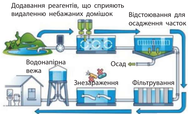
Мал. 22.3. Система водопідготовки перед подачею води у водогін
