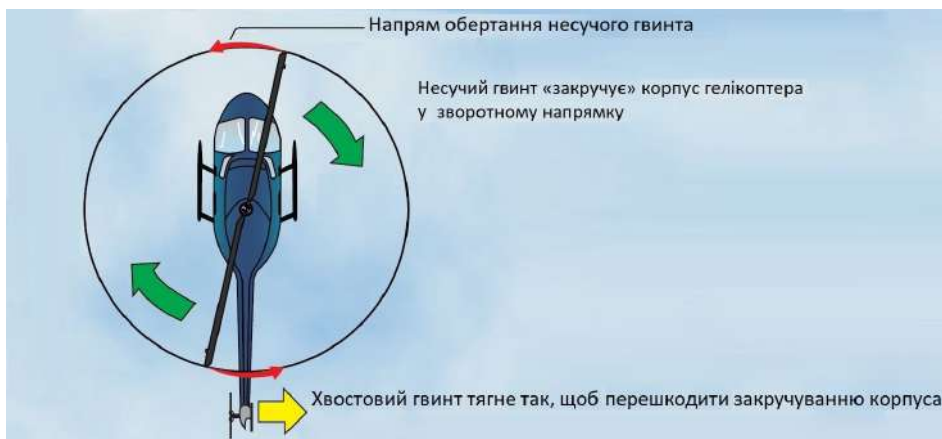
Мал. 15.15. Схематична будова гелікоптера
