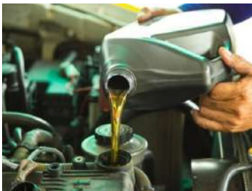
Мал. 37.9. Додоавання мастила зменшує тертя між металевими деталями
