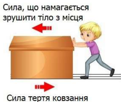
Мал. 37.2. Сила тертя ковзання й зовнішня сила спрямовані протилежно
