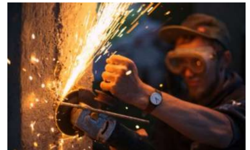
Мал. 37.7. Під час шліфування або розрізання пилові частинки настільки розігріваються, що починаються світитися
