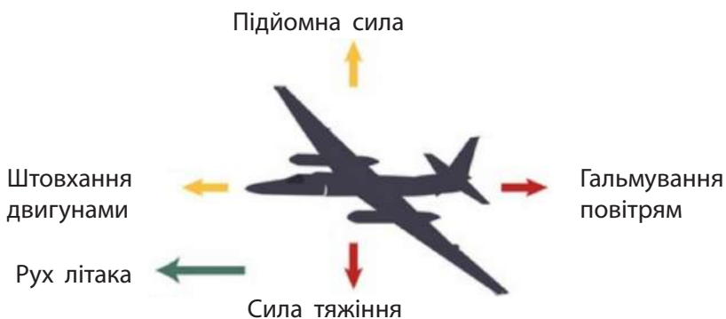
Мал. 15.12. Зліт літака можливий, якщо підйомна сила більша, ніж сила тяжіння до Землі
