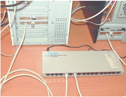
Мал. 2.4. З'єднання комп'ютерів з комунікаційним пристроєм за дротовою технологією
