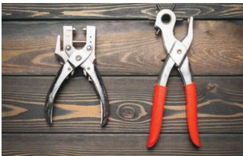
Мал. 15.12. Інструменти та пристосування для заклепкових з'єднань
