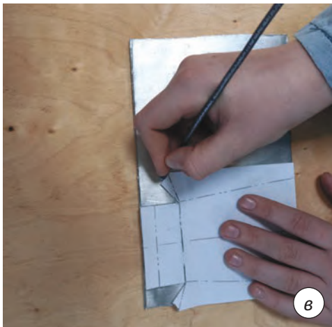
Мал. 15.6. Розмічання заготовки: а — проведення базової лінії; б — використання кутника; в — розмічання за допомогою шаблону
