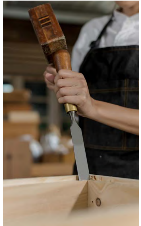
Мал. 18.10. Процес заглиблення долота
