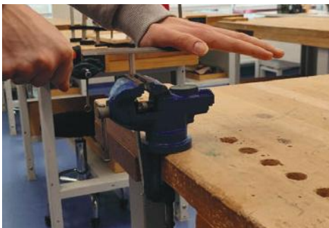
Мал. 15.9. Положення рук під час обпилювання
