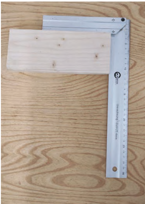
Мал. 18.9. Контроль показників за допомогою столярного кутника
